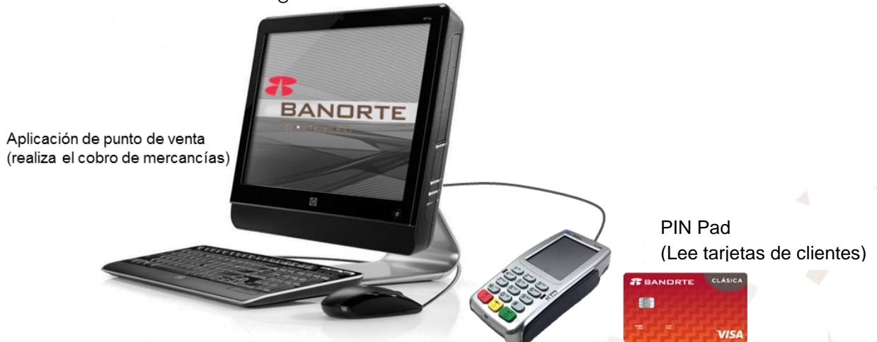
Figura 1. Instalación de PIN Pad
